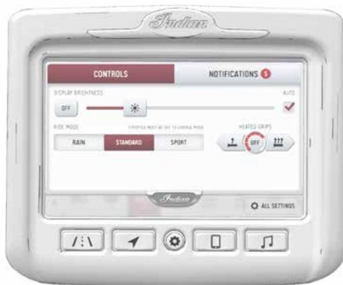
À partir du panneau de commande, vous pouvez accéder aux réglages, régler l'intensité de l'écran, sélectionner votre mode de conduite et régler les commandes de régulation climatique.
